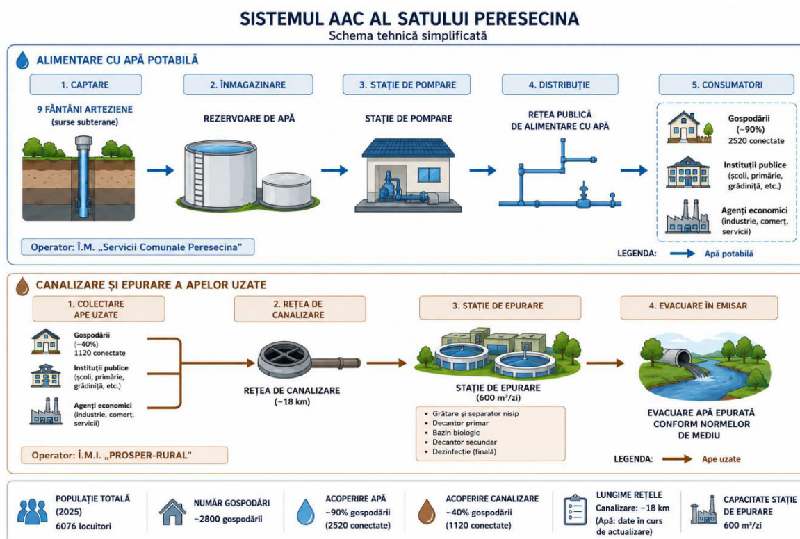
Figura 4. Schemă tehnologică conceptuală a sistemului centralizat de AAC
